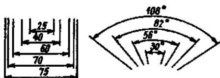
Рис. 6.23. Нанесение размеров на параллельных и концентрических размерных линиях
