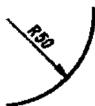
Рис. 6.31. Смещение размерной линии радиуса относительно центра дуги
