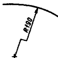
Рис. 6.30. Размерная линия радиуса с изломом
