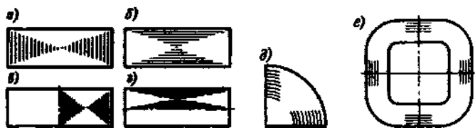
Рис. 11.17. Изображение шихтованных (а-г) и витых (д, е) магнитопроводов в разрезах и сечениях: а, б — в поперечных; в, г — в поперечных частичных; д, е — в продольных
