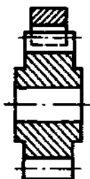
Рис. 10.7. Речное зацепление в разрезе
