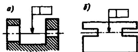
Рис. 7.12. Нанесение допуска, относящегося: а — к общей оси; б — к плоскости симметрии
