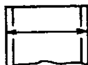
Рис. 6.20. Разрыв контурной линии для нанесения стрелок
