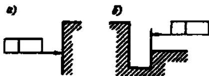
Рис. 7.6. Примеры допустимого расположения соединительной линии
