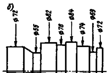
Рис. 6.45. Нанесение размеров отверстий с общей размерной линией и диаметров цилиндрического изделия сложной формы
