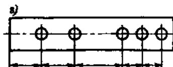
Рис. 6.4. Нанесение размеров: а, б — от общей базы; в — от нескольких общих баз; г — цепочкой
